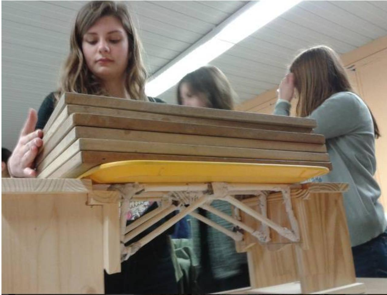
On pose des planches sur la structure pour vérifier si elle est assez résistante
